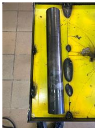
Figura 10. Tubo de acero utilizado como intercambiador de calor
