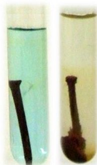
Figura 4. Oxidación del Fe en CuSO_4
