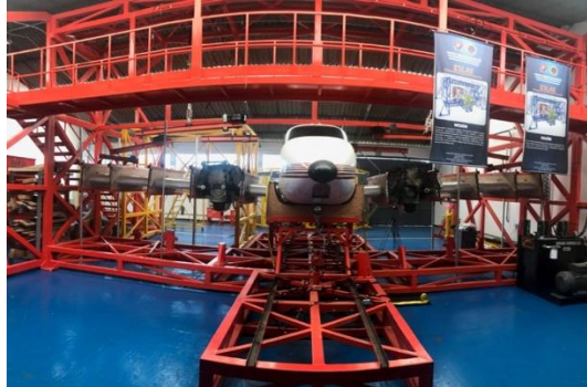
Figura 22. Montaje de la aeronave en el jig de ensayos
