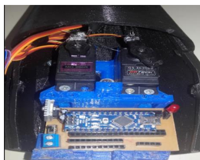
Figura 7. Encaje de circuitería en la prótesis impresa
